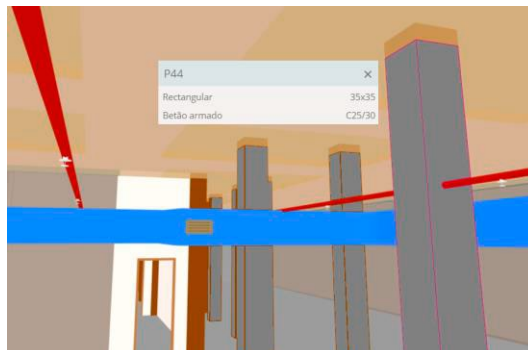
Figura 8. Colisão entre tubo da rede de sprinklers e pilar.
